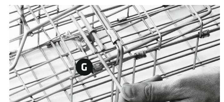
6. Premere sulla staffa di bloccaggio per poter piegare lo sportello anteriore verso l'alto. Questo si blocca automaticamente nel gancio di fissaggio della porta.
