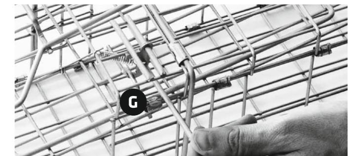
6. Appuyez maintenant sur le support de tension pour pouvoir rabattre la porte avant vers le haut. Il s'engage automatiquement dans le crochet de maintien de la porte.
