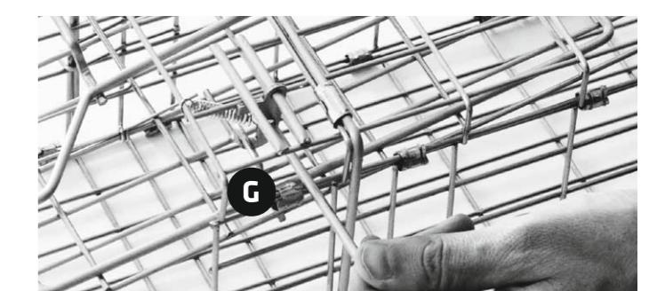
6. Druk nu op de klembeugel om de voorste deur naar boven te kunnen klappen. Deze wordt automatisch vergrendeld in de deurbestigingshaak.
